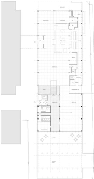
Mit einem eingeschossigen Anbau wird die bestehende Mensa erweitert. Das Volumenprofil des Altbaus wird übernommen und additiv gegen Süden entwickelt.
